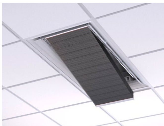
Figur 13. Demontering av underplåt samt fällning av batteri för noggrann rengöring vid höga hygienkrav. Obs! kräver att produkten beställs med tillbehöret, fällbart batteri, samt att flexibla anslutningsslangar används på vattensidan.
